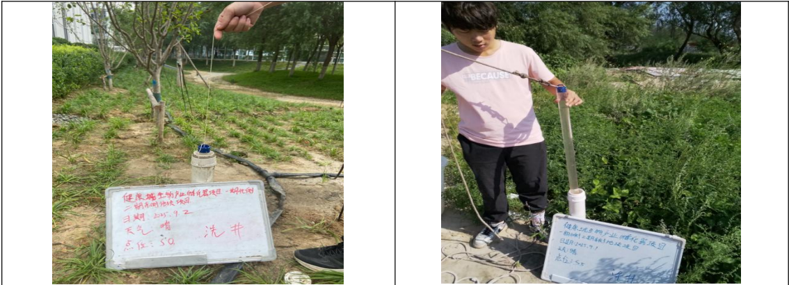
图5.3-5地下水监测井洗井照片
