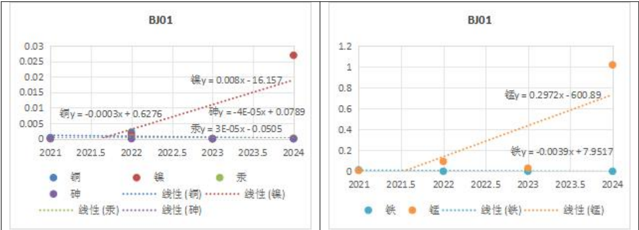
对比 BJ01 点位 4 年地下水，铜、铁、砷趋势线斜率 K < 0 ，呈现下降趋势；汞趋势线斜率 K = 0 ，呈现基本稳定；镍、锰趋势线斜率 K > 0 ，呈现上升趋势。
