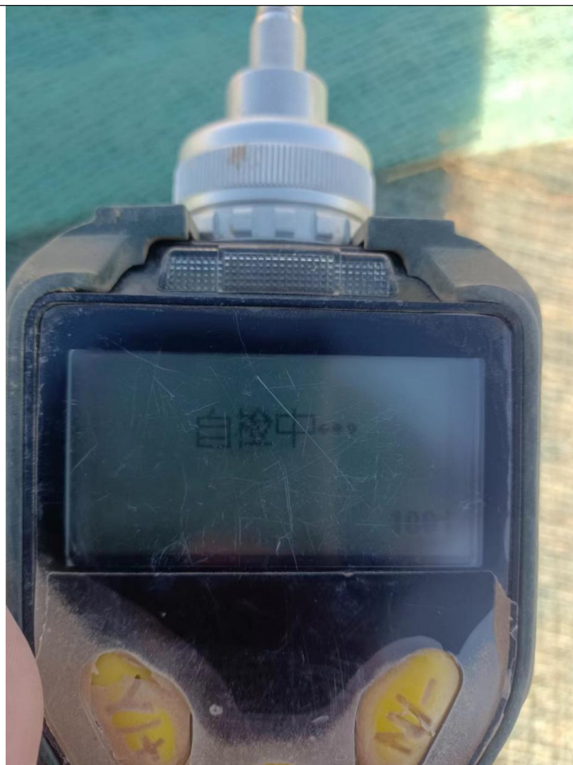
现场快筛仪器校准照片：离子气体检测仪（PID）
