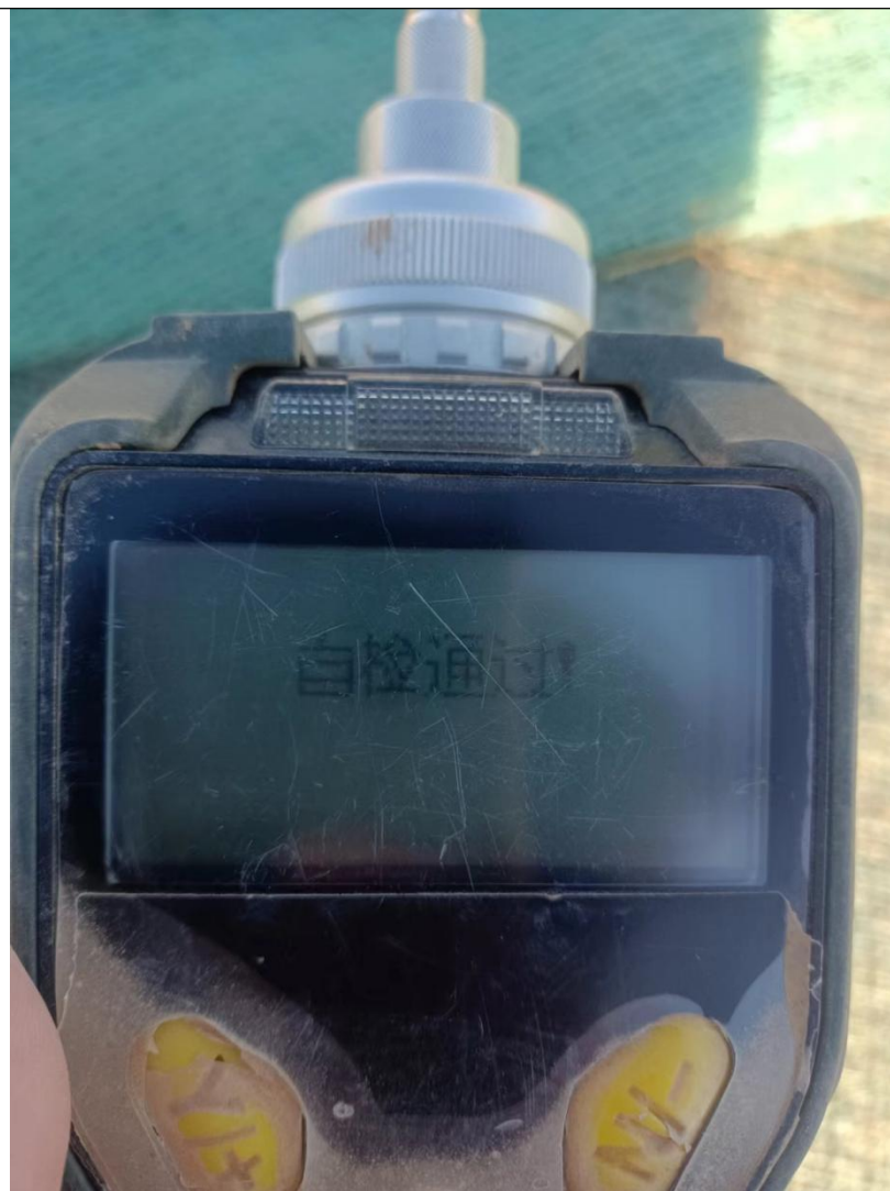
现场快筛仪器校准照片：离子气体检测仪（PID）
