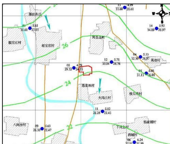
图3.3-1 浅层地下水等水位线图
