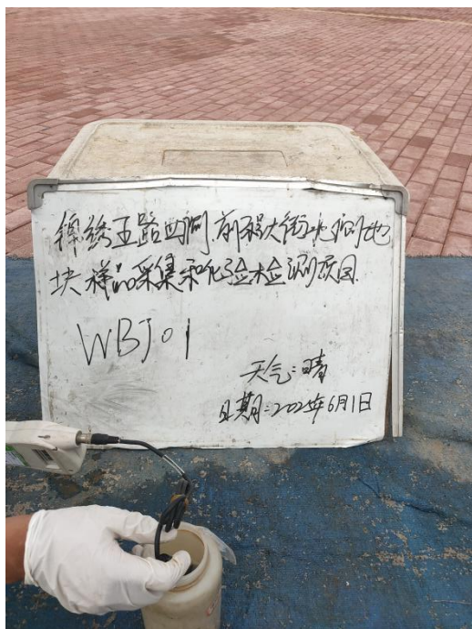
WBJ01-现场氧化还原电位检测
