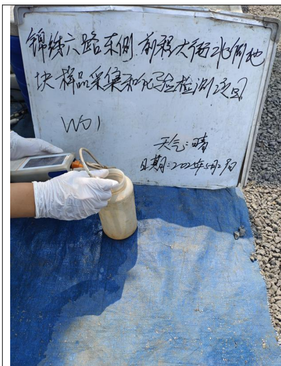
W01-现场电导率检测
