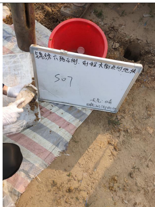
S07-SVOC 样品装满压实
