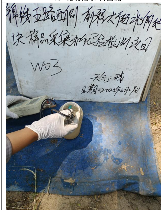
W03-现场氧化还原电位检测
