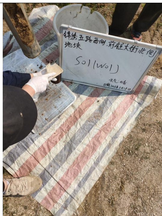
S01-SVOC 样品装满压实
