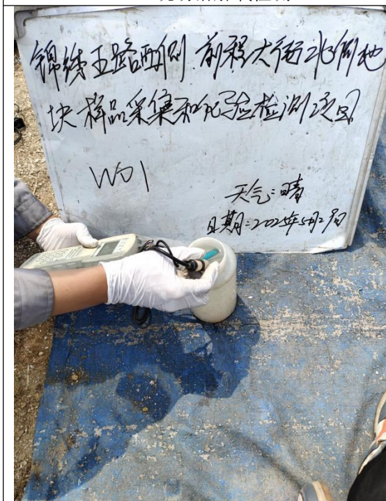
W01-现场氧化还原电位检测
