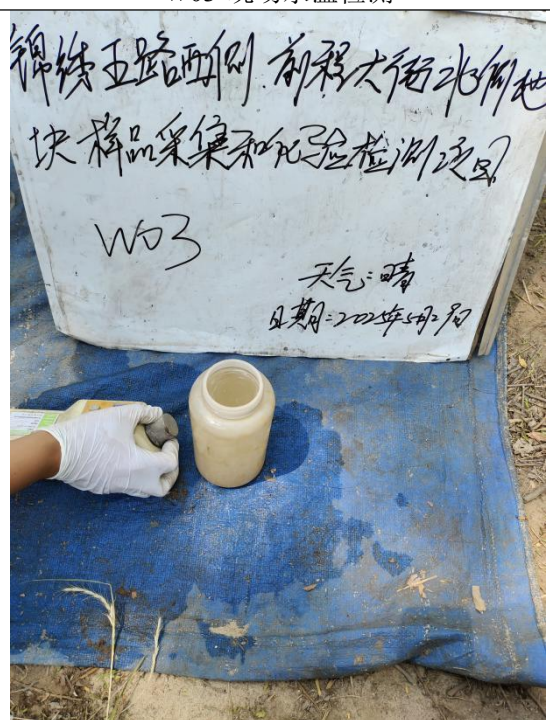
W03-现场浊度检测
