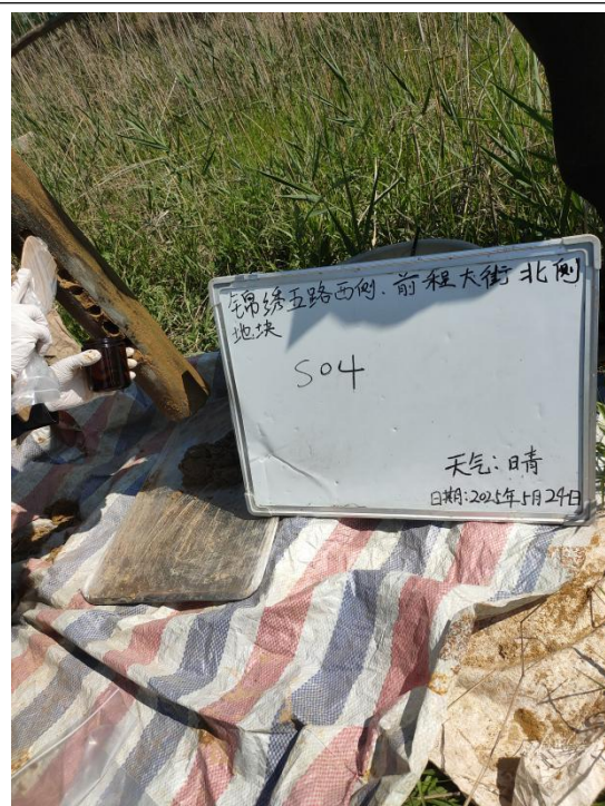
S04-SVOC 样品装满压实
