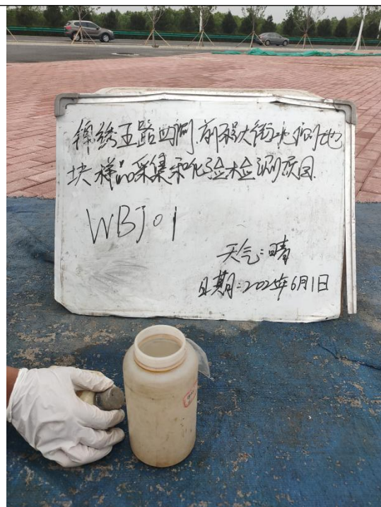
WBJ01-现场浊度检测
