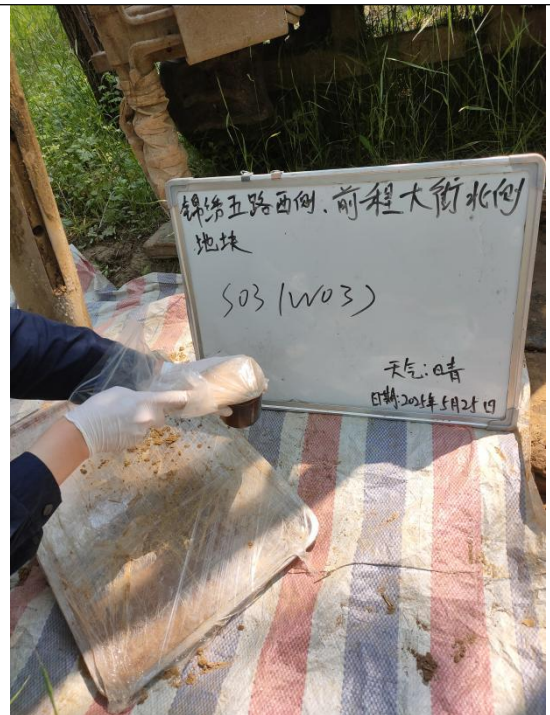
S03-SVOC 样品装满压实
