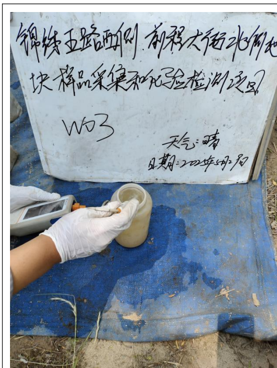
现场电导率检测
