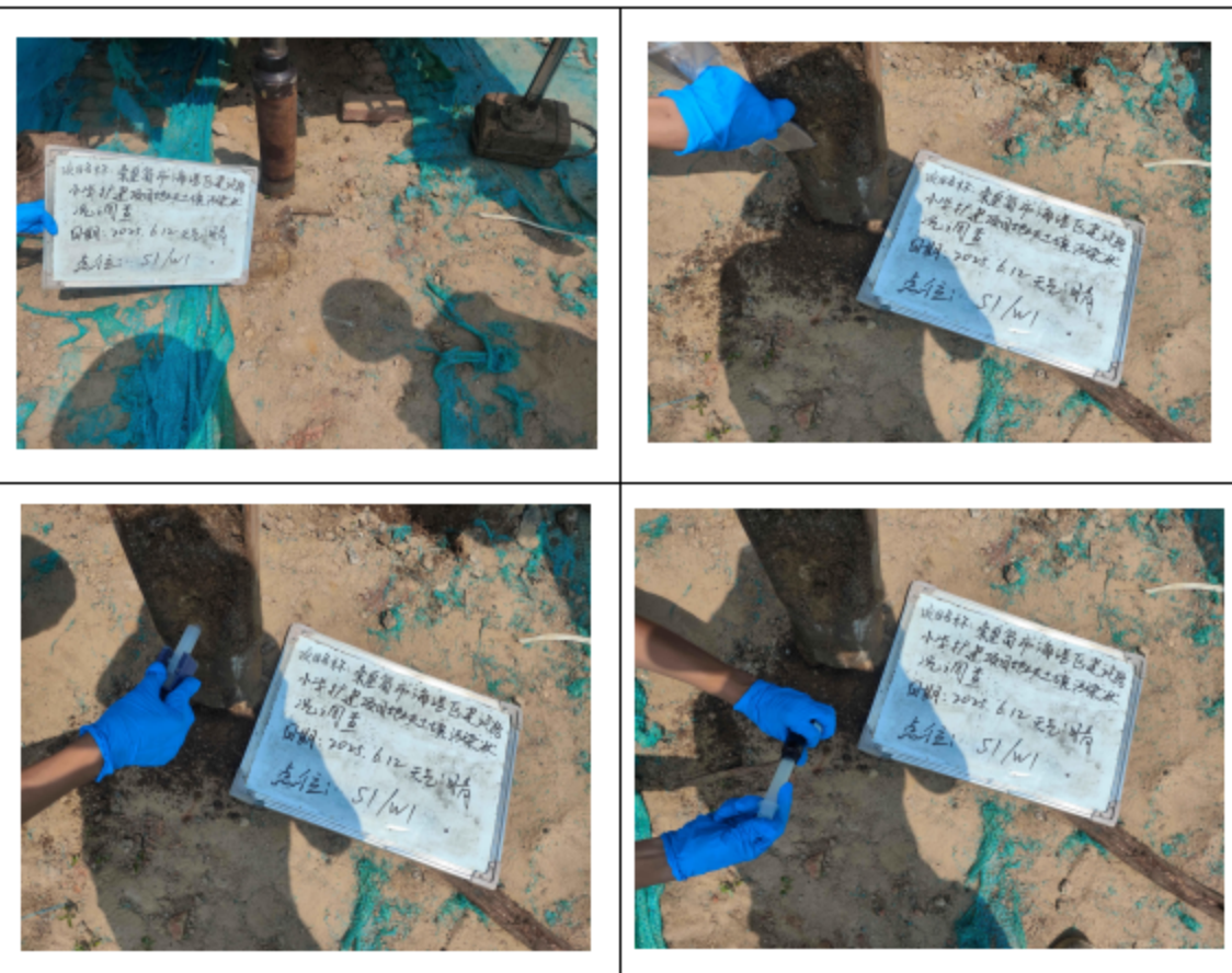
套管跟进、VOCs 取样照片
