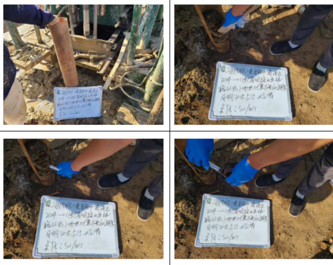
套管跟进、VOCs 取样照片
