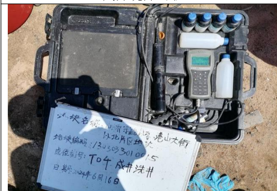
成井洗井现场快检
