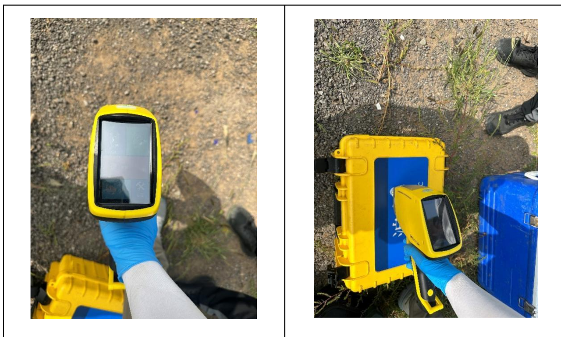
图 5.3-4 快筛设备现场校准照片
