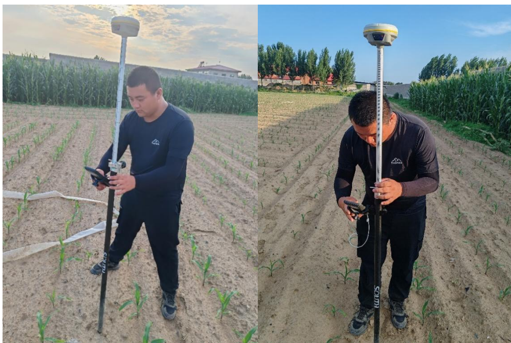
图 5.3-2 现场 RTK 定点
