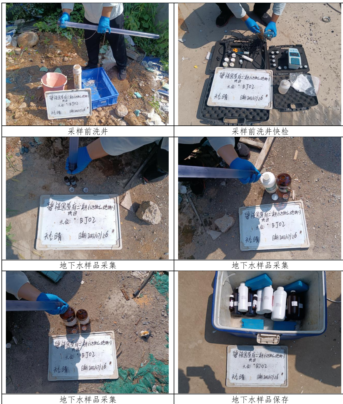
图 6-3 建井及现场采样典型照片
