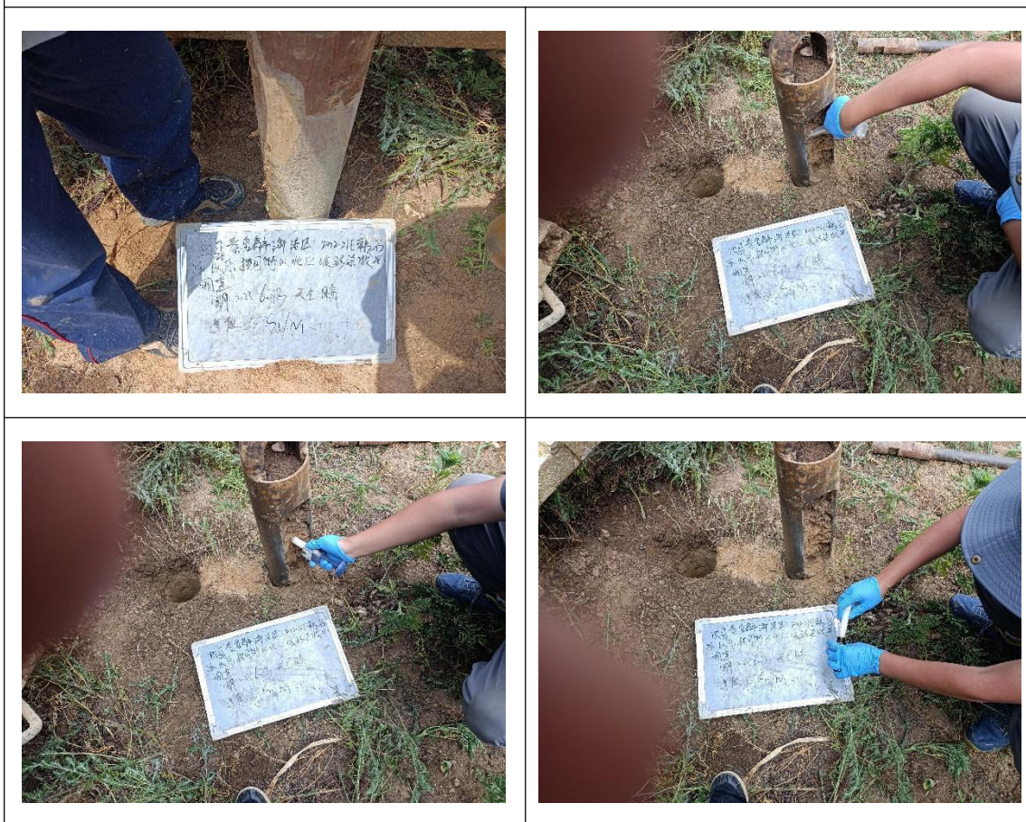
VOCs 取样照片
