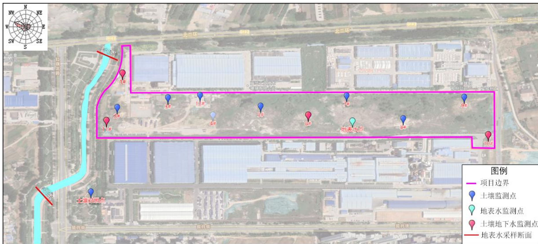
图 5-1 调查地块土壤、地下水采样布点图
