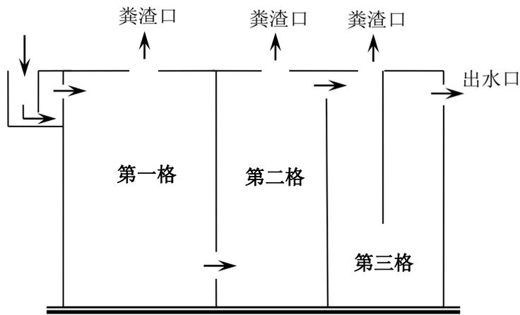
图 B.1-1 典型三格化粪池结构示意图
