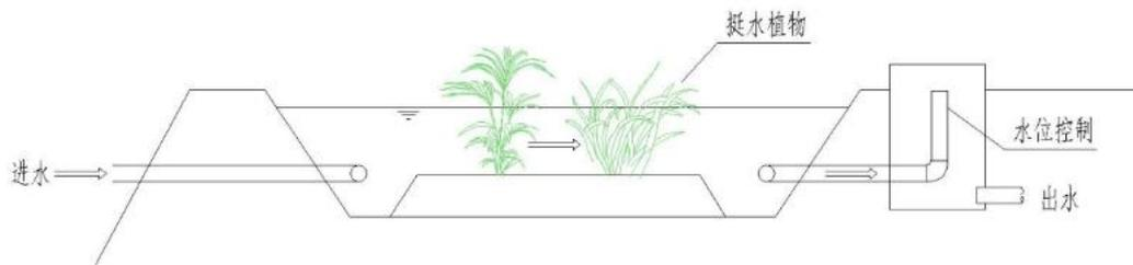
图 B. 6-4 表面流人工湿地构造示意图
