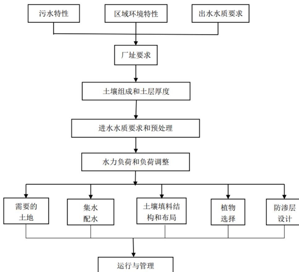
图 B. 7-1 土壤渗滤设计流程图
