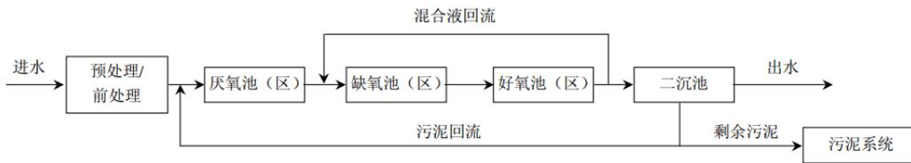
图 B. 3-4 厌氧缺氧好氧工艺流程图
