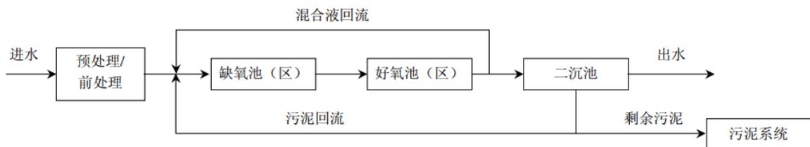
图 B. 3-3 缺氧好氧工艺流程图
