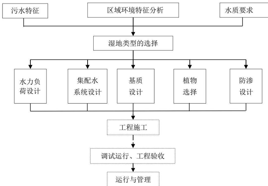
图 B. 6-1 人工湿地处理技术设计程序
