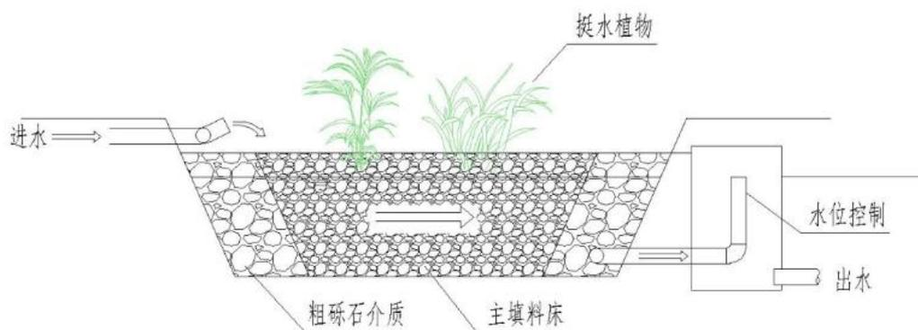
图 B. 6-5 水平流人工湿地构造示意图
