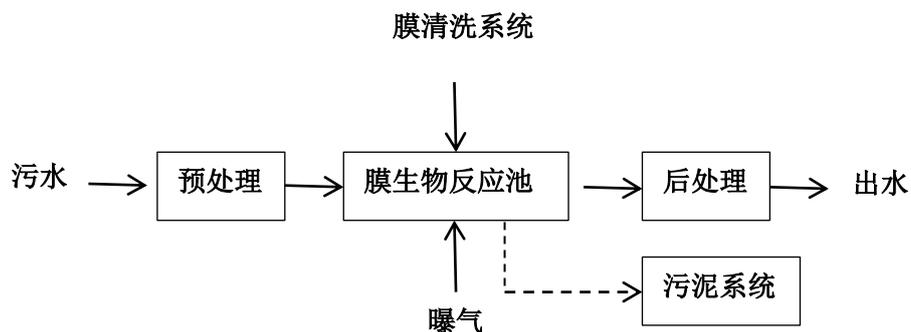
图 B. 5-1 MBR 法工艺流程图
