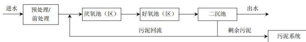
图 B. 3-2 厌氧好氧工艺流程图
